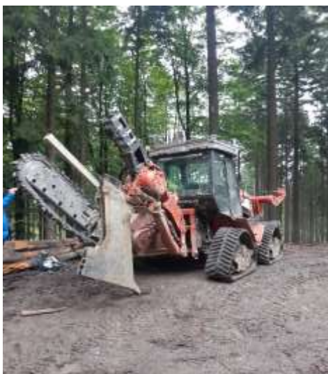
Vibrační pluh s připojenou frézou pro skalnaté podloží a detail z pokládky médií
